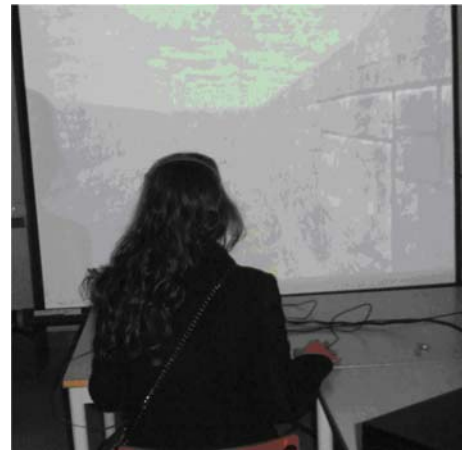
Figura 2. Configuração usando um projector de vídeo e uma tela colocada perto do utilizador.
