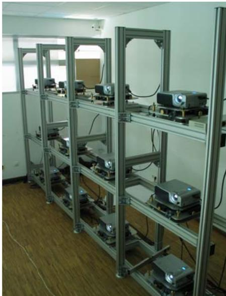
**Figura 3: Estrutura de suporte dos projectores**
