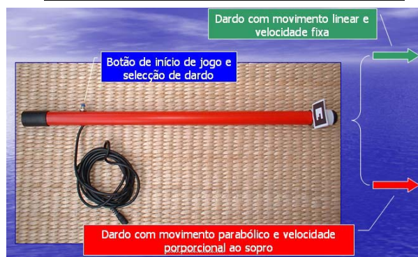
Figura 9 Construção do Hardware do Protótipo da Interface Tangível Zarabatana.
