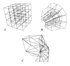
**Figure 1:** *Grids - A) Rectilinear, B) Curvilinear, C) Unstructured*
